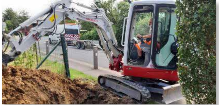
Une mini-pelle (matériel d'occasion) pour réaliser des tranchées, curer des fossés, etc...
