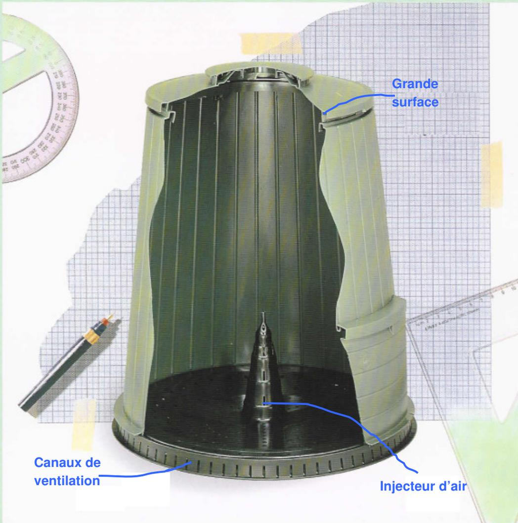
Pour pouvoir optimiser la ventilation de l'air SULO a payé beaucoup d'attention au fond du fût. Il possède des canaux d'aération et un injecteur d'air pour maximiser l'entrée d'air. Les canaux d'aération divisent de façon égale le flux d'air. L'injecteur d'air apporte de l'air à l'intérieur du tas de compost. Au total il y a une superficie de 16.000 mm<sup>2</sup> de contact entre l'air et le compost. On peut dire ainsi qu'il y a une aération optimale.
